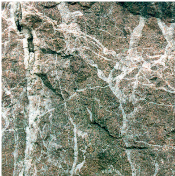
Breccia. Sprickorna mellan granitbrottstycken har fyllts upp med kvarts.
